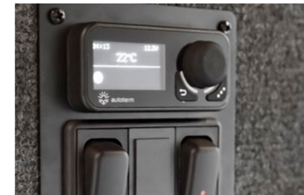
Warmluftheizung mit Multicontrol für eine einfache und komfortable Temperaturregulierung im Innenraum.
