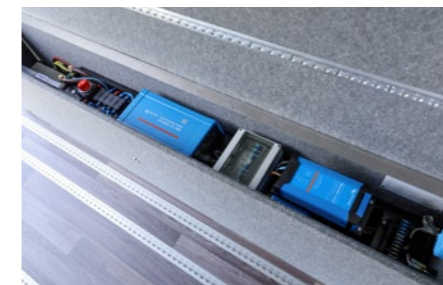
Bei allen Elektro-Paketen inklusive Ladegerät für Aufbau- und Starterbatterie, DC-DC-Ladestecker; 2x USB-Ladebuchse geschaltet, 5x 12-V-Ladesteckdose, CE-Steckdose für Landanschluss, 3x 230-V-Steckdose im Innenbereich, 8x LED-Spots, zwei Schalter für je 4 LED-Spots geschaltet, digitale Anzeige für die Spannungsversorgung, Kabelvorbereitung Klima- und Solaranlage.
