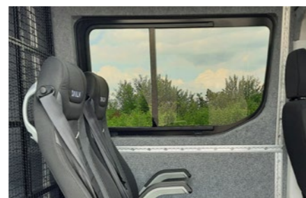
Abgedunkelte Seitenscheiben Einfachverglasung mit Schiebefenster in Schiebetür und gegenüber.
