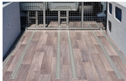
Airlineschienensystem am Boden, Dach und an Seitenwänden zur schnellen Befestigung und Verschiebung von Ausstattung oder Fracht.
