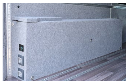
Radkastenverkleidung links, Staufach für Elektro-Paket leicht zugänglich, für eine sichere Unterbringung.
