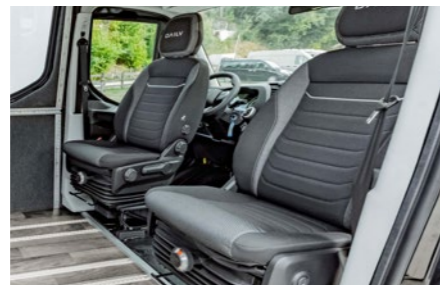
Drehkonsole für Fahrer- und Beifahrersitz mit individuell verstellbaren Komfort-Reisesitzen.
